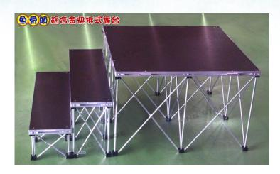
檯面 1 米×1 米×35mm 表面為格狀止滑防刮美耐板,單片的乘載重量可以 達到 1000 公斤,舞台腳高度有 40 公分、60 公分、80 公分、1 米等可選 擇,台階為 1 米×28 公分×35mm 高度有 20 公分、40 公分、60 公分、80 公分可搭配舞台高度來做調整台階數。 重量輕、組裝方便。
